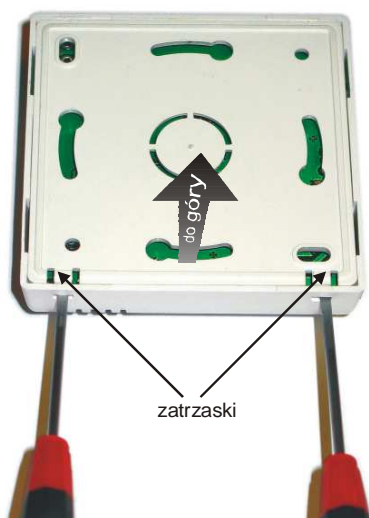
Rys.14.1. Demontaż ścianki tylnej
