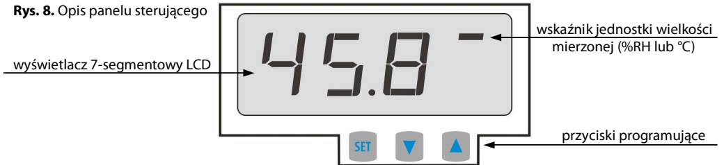
Rys. 8. Opis panelu sterującego
