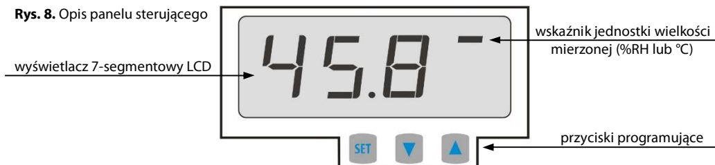
Rys. 8. Opis panelu sterującego
